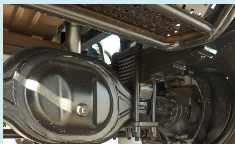
Hệ thống treo trước 9 lá Cầu sau 5 tấn - tỉ số truyền 6,72
