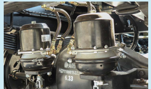
Hệ thống phanh tang trống dẫn động khí nén
