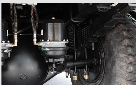
Hệ thống treo sau: nhíp chính 10 lá, nhíp phụ 8 lá Cầu sau 10 tấn - tỉ số truyền 6,5
