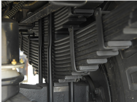
Treo trước sau kiểu phụ thuộc, 9 là nhíp trước, 13 là nhíp sau và 8 là nhíp phụ, giảm chấn thủy lực
