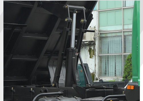
Hệ thống ben HG-F160x600; đường kính 160mm và HG-F180x660; đường kính 180 mm
