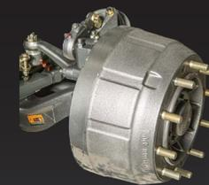
Hệ thống phanh tang trống dẫn động bằng khí nén 2 dòng.
