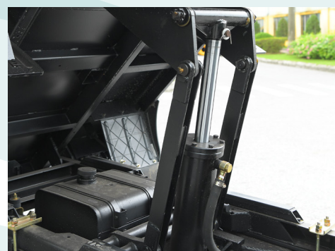
Hệ thống ben đường kính 100mm đối với bản 240D - đường kính 125 mm đối với bản 400D
