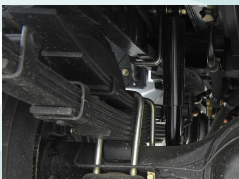
Treo trước sau kiểu phụ thuộc, 6 lá nhíp trước, 10 lá nhíp sau, giảm chấn thủy lực
